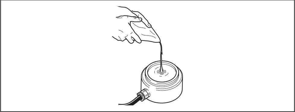
Fig. 4.2 Empotage du bornier – Transmetteur WaterMaster FET1
