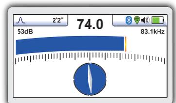
**Écran classique**- Affiche un signal maxi lors de la localisation. L'indicateur du compas devient bleu lorsqu'il est dans l'axe du réseau.
