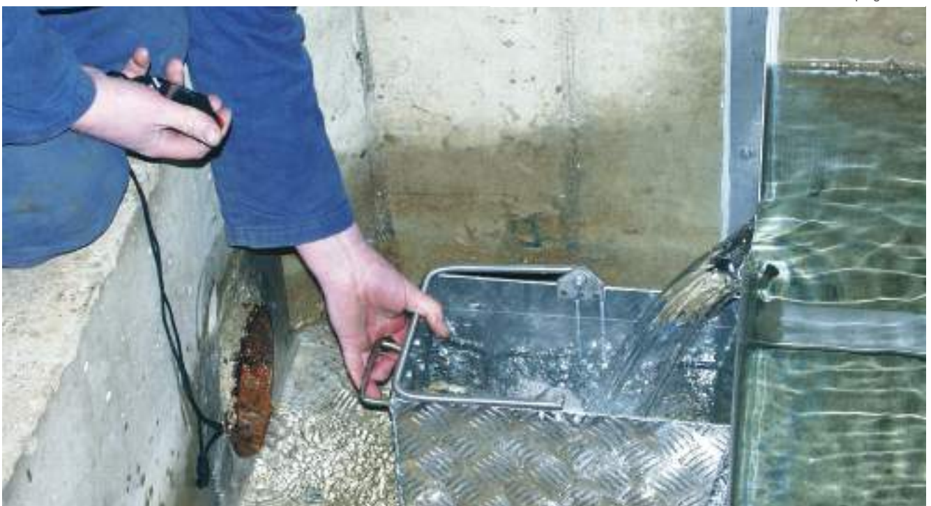
Mesure de débit sur captage d'eau
