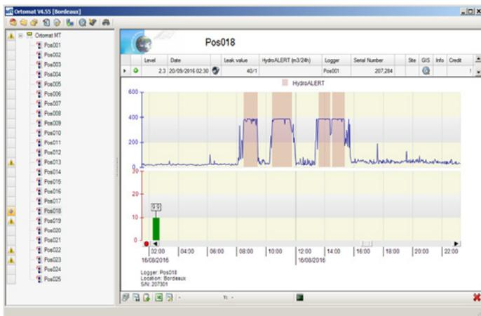
Les **ORTOMAT-MT** équipés de capteurs acoustiques détectent tous les bruits répondant à des critères définis tels que: horaires, durée, fréquences, intensité... Leurs données sont ensuite transférées sur la plateforme web vonRoll Hydroport, pour exploitation.
