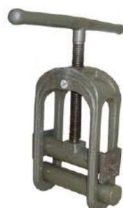
Écrase-tube 20-63 / Permet par compression, l'obturation rapide en cas de fuite des tuyaux PE sans les blesser / Pour tuyau DN 20 à 63 mm / Disques latéraux réglables selon le DN pour éviter les déformations par pincement
