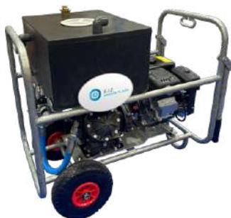
Pompe thermique / Débit max : 40 l/min / Pression max : 40 bar / Réservoir : 30 l / Poids total : 55 kg / Encombrement : 110 x 68 x H80 cm (y compris poignées) / Moteur essence 5,5 CV (lanceur à main) / Réglage de la pression d'épreuve par molette, manomètre de contrôle de la pression d'épreuve
