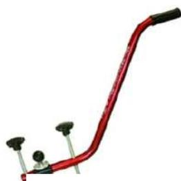
Pioche d'égoutier / Pour manipuler les plaques d'égoût / Côté panne pour dégager l'enrobé des bords de la plaque / Côté crochet pour soulever et faire glisser la plaque / Poids : 1,3 kg / Hauteur totale : 900 mm
