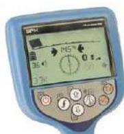
Écran avec un menu intuitif qui rend le RD facile d'accès et d'emploi. Boussole et compas pour suivre l'orientation du réseau cible.
