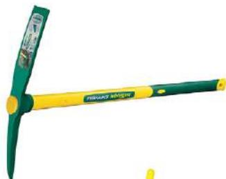
Pioche de terrassement / Idéal pour les travaux de terrassement, de voirie, etc... / Pointe diamant et panne affûtée, trempées pour une meilleure résistance à l'usure / Un côté panne pour creuser et un côté pic pour dépierrer / Douille ronde Ø 47 / Poids tête : 2 kg / Hauteur tête : 550 mm / Largeur de tête : 60 mm / Manche : 1000 mm
