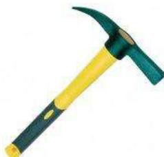
Marteau d'égoutier / Outil 3 en 1 / Pour soulever les plaques d'égoût / Côté "bec" pour soulever les plaques (ou tampons) / Côté "marteau" pour taper sur les plaques afin de les décoller de leur support / Côté "poignée" pour tirer la plaque hors de la bouche d'égoût / Section ronde de la poignée + gaine / Manche composé de 2 ronds en acier de 16 mm soudés / Poids total : 3,275 kg / Longueur totale : 900 mm
