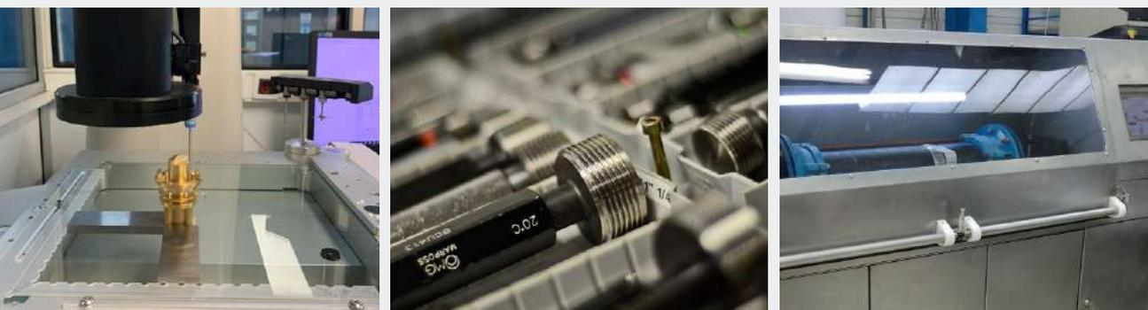
**Tests de vieillissement accélérés** avant la validation des produits, contrôles dimensionnels des produits et des composants, tests d'étanchéité unitaires de tous les robinets avant leur sortie d'usine.
