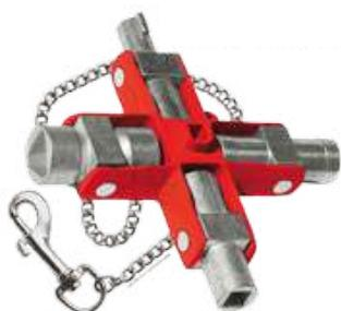
Clé universelle à 8 empreintes / Clé universelle pour fermetures de chantiers / Le double mécanisme pivotant permet de libérer et positionner 8 clés pour toutes les serrures courantes du marché / Se compose de 8 empreintes : carrés 6, 7/8 et 9/10 mm, triangles 7, 8/9 et 10/11 mm, panneton 3/5 mm, demi-lune 6 mm, carré de 5 mm pour la purge de radiateurs / Chaîne et mousqueton pour accrochage à la ceinture
