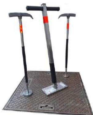
Souleveur magnétique 3 en 1 / Idéal pour l'ouverture des bouches à clés, couvercles et grilles en fonte / Pointe de marteau polyvalente permettant le nettoyage des couvercles et de leur cadre / Fonctionne même avec les couvercles endommagés et sales / Gain de temps / Ultra compact : H 67 cm / Ø 60 mm en 130 kg, Ø 80 mm en 220 kg, carré en 400 kg
