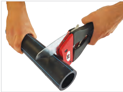
1 Couper le tube perpendiculairement avec un coupe-tube pour PE.
