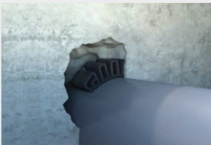
Ancrage du tube dans un mur
