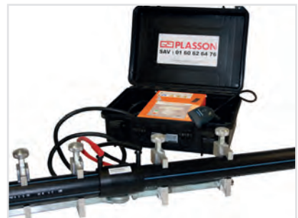
6 Immobiliser l'ensemble raccord + tubes à l'aide d'un positionneur.
