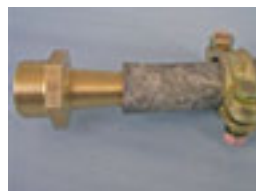
Laisser le collier en retrait et visser une première fois le raccord pour commencer à créer un pré filetage intérieur.
