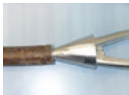
Arrondir le plomb à l'aide d'une pince à évaser.
