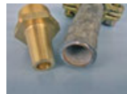
Démonter le raccord. Une empreinte de filetage apparaît dans le tube.
