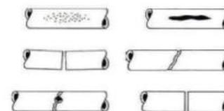
Les manchons de réparation ISIFLO MF en inox sont prévus pour la réparation durable de tuyaux endommagés véhiculant de l'eau potable ou d'irrigation, assainissement ainsi que dans le domaine du bâtiment et de l'industrie. Ils peuvent être appliqués sur de l'Acier malléable, Acier revêtu PE, Acier, Amiante ciment, Fonte, Vieille fonte, PVC, PE véhiculant de l'eau tempérée (maxi 40°C).
