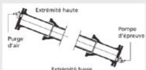
⚠ Évaluer les efforts hydrauliques développés sur les extrémités de la conduite et mettre en place un système de butées correctement dimensionnées.
