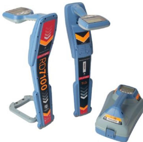
Avec quatre fréquences de sonde, le RD7100DL peut être utilisé pour localiser des conduites non métalliques profondément enterrées de différents matériaux : fonte, argile, fibre, béton et brique. Il permet également de détecter les signaux des systèmes de protection cathodiques (CPS) appliqués aux pipelines.
