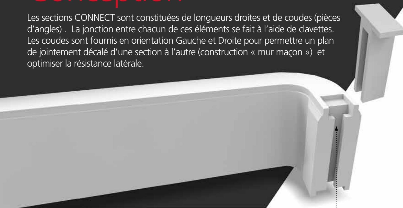
Lors du montage sur site d'une chambre Ultima CONNECT on veillera à respecter le principe d'alternance en commençant soit par une section construite avec des coudes Droit soit par une section construite avec des coudes Gauche.
