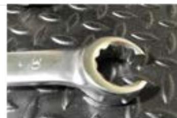
Clef à tuyauter 30 : maintenance des flexibles
