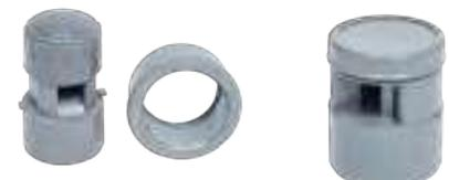
Le clapet aérateur permet le remplacement partiel des primo-ventilations de chutes séparatives de l'habitat. Les odeurs sont piégées par la face supérieure de la membrane qui obture l'air de la chute. Pour éviter le désiphonnage, lors d'une vidange, la membrane se soulève pour permettre l'apport d'air indispensable
