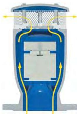
Couvercle en fonte ductile et panier en inox en standard pour empêcher l'entrée d'insectes (d'autres sorties d'air en option pour applications immergées, entrée d'air seule, sortie d'air seule)
