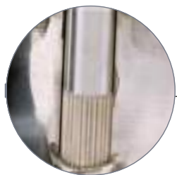
Papillon maintenu par cannelures supprimant tous les jeux mécaniques
