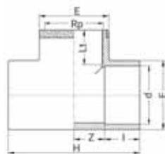
Té à 90° avec bague de renfort - A coller sur d - Taraudé sur Rp
