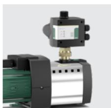
L'automatisme de contrôle de pompe HiControl 1 protège la pompe contre le manque d'eau et gère les marches/arrêts de la pompe selon les conditions de débit/pression de l'installation.
