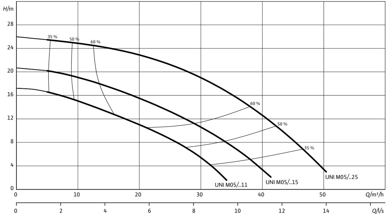
Les niveaux de rendement spécifiés correspondent au rendement hydraulique.
