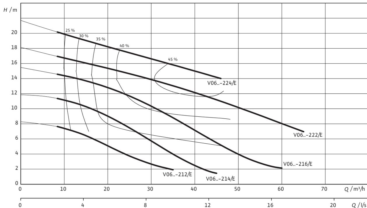
Performances hydrauliques selon ISO 9906, annexe A. Les rendements indiqués correspondent au rendement hydraulique.
