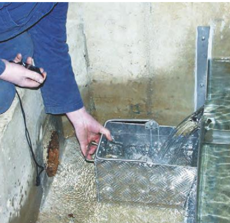
Mesure de débit sur captage d'eau.
