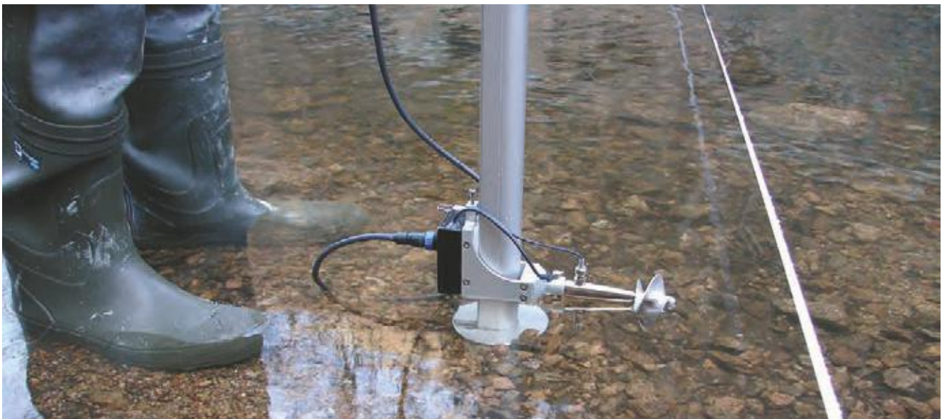
Jaugeage au moulinet : travaux pratiques de courantométrie.
