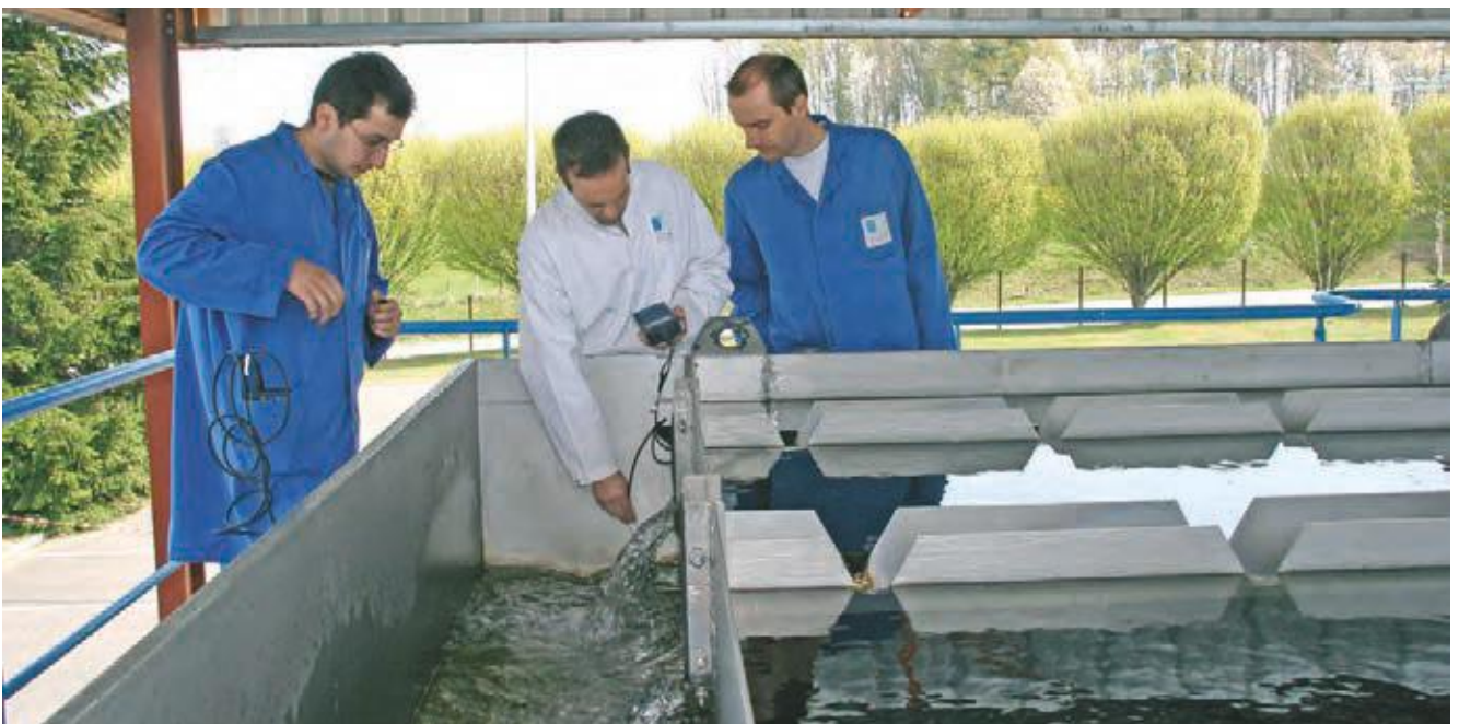
Contrôle de pH sur pilote de traitement d'eau.
