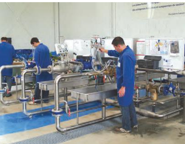
Travaux pratiques sur banc disconnecteurs.
